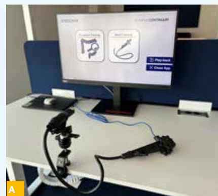
Bild A Ohne weiteres Zubehör für das Training endoskopischen Handlings bestimmt: EndoNix®, der virtuelle Endoskopie-Simulator mit einem 3D-gedruckten Endoskop-Handgriff
