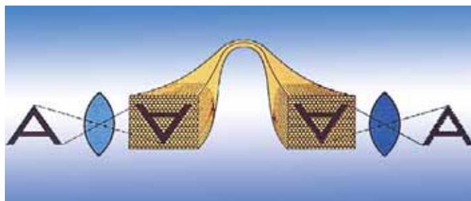
Um ein präzises Bild zu übertragen, sind die Bildleiterfasern des Fiber-Endoskops präzise angeordnet worden
