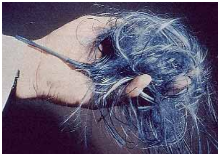
Kein Toupet oder Staubwedel, sondern ein zu feucht gewordenes Fiber-Endoskop auf dem Weg in den Sondermüll
